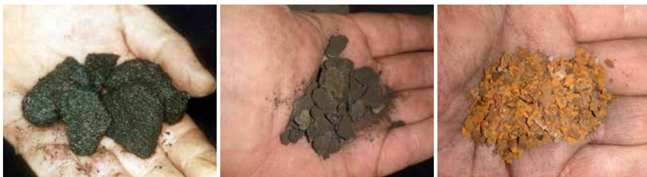
Figure 6 ● Types de dépôts (de gauche à droite) : morceaux de magnétite ; écailles provenant de la chaudière, tartre avec un peu de magnétite ; écailles provenant du chauffage par le sol, sans tartre.
