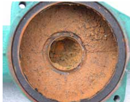
Figure 3 ● le corps de la pompe, partie intérieure (de gauche à droite): Ok!, magnétite, mais oxygénée, mauvais signe
