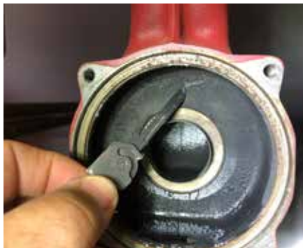
Figure 3 ● le corps de la pompe, partie intérieure (de gauche à droite): Ok!, magnétite, mais oxygénée, mauvais signe
