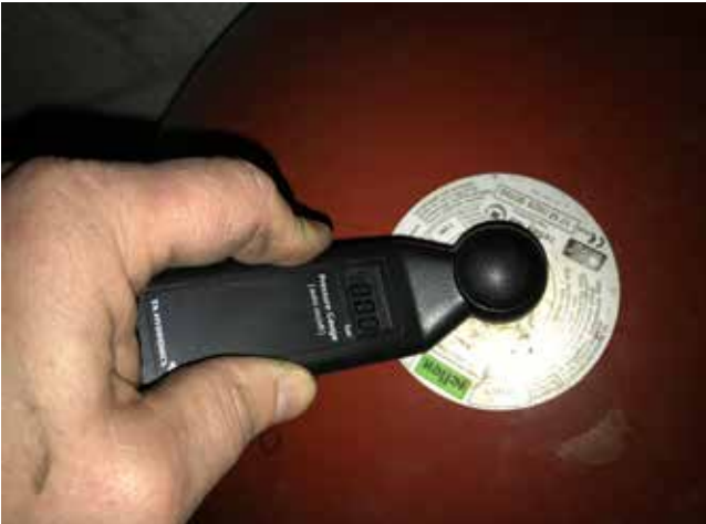
Figure 4 ● Mesure de la pression initiale. Pour mesurer la pression initiale – très importante – le vase doit donc être vide. Il vous faut une vanne d'isolement (capot protecteur de valve) et une vanne de vidange.
