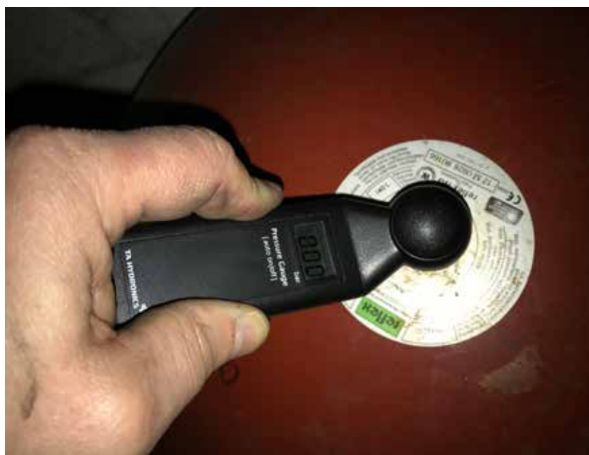
Figuur 4 ● Voordrukmeting. Om de voordruk te kunnen meten – die erg belangrijk is – moet het vat dus leeg zijn. Dus heb je een afsluitkraan (kapventiel) en aftapkraan nodig.
