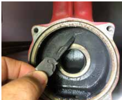
Figuur 3 ● Inwendige pomplichaam (van links naar rechts): Ok!, Magnetiet niet goed, Zuurstofrijk
