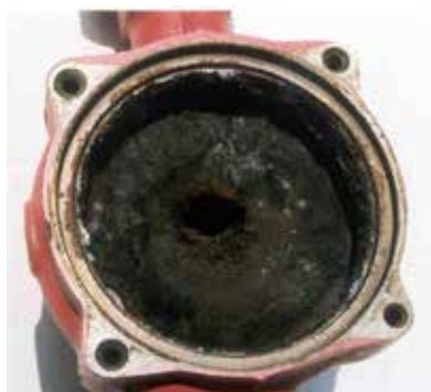
Figuur 3 ● Inwendige pomplichaam (van links naar rechts): Ok!, Magnetiet niet goed, Zuurstofrijk
