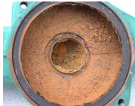
Figuur 3 ● Inwendige pomplichaam (van links naar rechts): Ok!, Magnetiet niet goed, Zuurstofrijk
