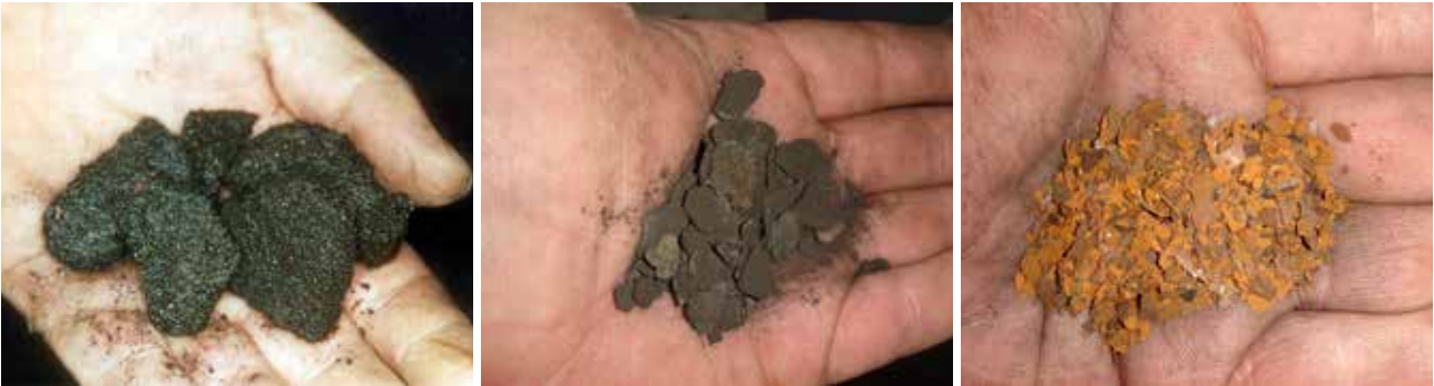
Figuur 5 ● Soorten afzetting (van links naar rechts): Brokken magnetiet; Schilfers uit ketel, kalk met een beetje magnetiet; Schilfers uit vloerverwarming, zonder kalk
