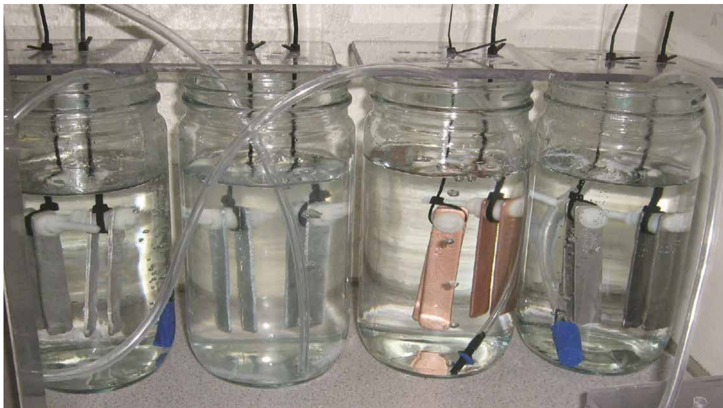
Een directe monitoring van corrosievorming door middel van 'corrosiecoupons' die regelmatig visueel gecontroleerd worden
