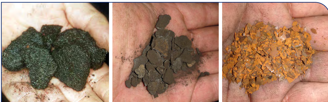
Fig. 21 - Soorten afzetting (van links naar rechts): Brokken magnetiet; Schilfers uit ketel, kalk met een beetje magnetiet; Schilfers uit vloerverwarming, zonder kalk
