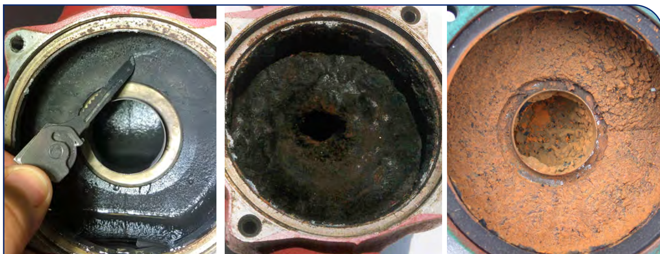
Fig. 18 - Inwendige pomplichaam (van links naar rechts): Ok!, Magnetiet niet goed, Zuurstofrijk
