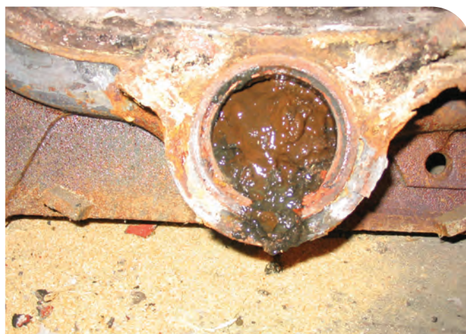
Fig.2 - Slib, samengesteld uit verschillende corrosieproducten van ijzer (roest (rood), magnetiet (zwart)), dat aanwezig is op de bodem van een warmtegenerator.
