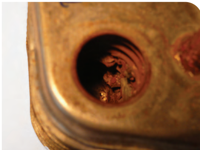
Fig. 4 - Verstopping van de primaire zijde van een platenwarmtewisselaar door schilfers.
