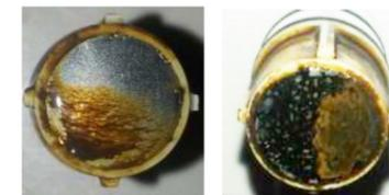
Abb.: Korrosionscoupons, die teilweise mit einem Inhibitorfilm abgeschirmt sind
