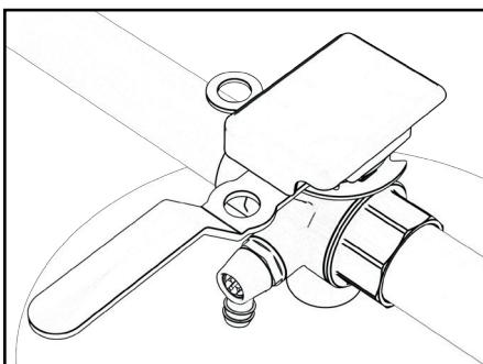
4. Raccordez un tuyau à la décharge de la vanne de vidange et videz complètement le vase d'expansion.
