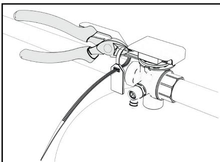
3. Draai de hendel van het kapventielarmatuur loodrecht t.o.v. de leiding, zodat het expansievat van de installatie wordt afgesloten.
