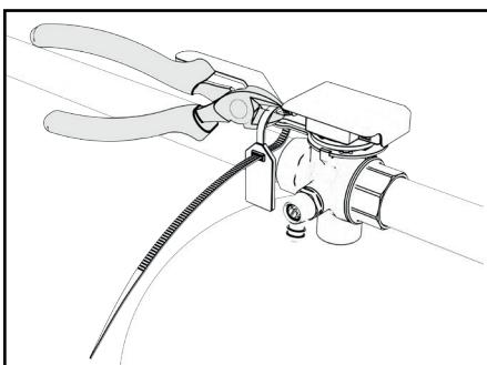
3. Tournez la manivelle de l'armature de vanne à capuchon perpendiculairement au tuyau afin de fermer le vase d'expansion de l'installation.
