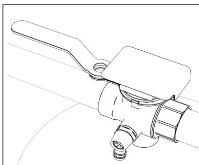
8. Sécurisez cette position à l'aide de l'attache autobloquante fournie. Notez la date de la mise en service sur l'étiquette de cette attache autobloquante. Il est également possible de sécuriser à l'aide d'un boulon et d'un écrou ou d'un verrou (dans le trou prévu à cet effet), par exemple.
