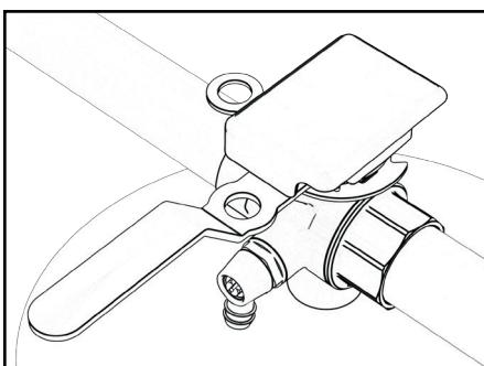
4. Schließen Sie einen Schlauch an den Schlauchstutzen an und öffnen Sie das Ablassventil, um das Ausdehnungsgefäß vollständig zu entleeren.
