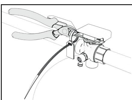
3. Stellen Sie den Betätigungsgriff der Kappenventilarmatur senkrecht zur Leitung, so dass das Ausdehnungsgefäß der Anlage abgesperrt ist.
