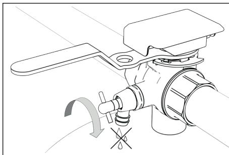
7. Draai de hendel  $90^\circ$  in uurwijzerzin tot in zijn normale werkingspositie (=volle doorlaat).
