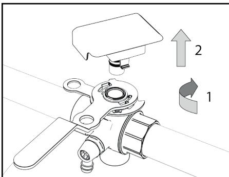
6. Ein neuer Korrosionsmonitor kann wie ab Schritt 3 unter Montage in *Kapitel 6 - Einbau* beschrieben eingebaut werden.
