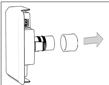
5. De corrosiemonitor kan vervolgens d.m.v. bajonet montage in de armatuur geplaatst worden. Let er op dat u de sondetip niet beschadigt bij het inbrengen.
