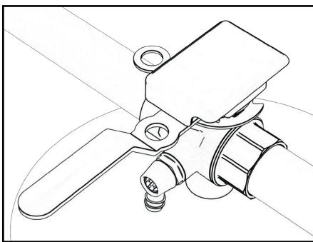
4. Sluit een slang aan op de slangpilaar en open de aftapkraan om het
