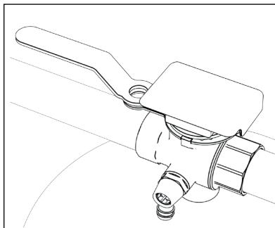
8. Borg deze positie d.m.v. de bijgeleverde kabelbinder. Schrijf op het label van deze kabelbinder de datum van ingebruikname. Borging met bijvoorbeeld een bout en moer of hangslot (in de daarvoor voorziene gaten) is ook mogelijk.
