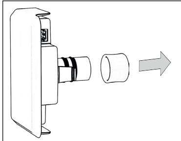
5. Dann kann der Korrosionsmonitor mit dem Bajonettverschluss an der Armatur befestigt werden. Achten Sie darauf, dass Sie die Sondenspitze beim Einsetzen nicht beschädigen.
