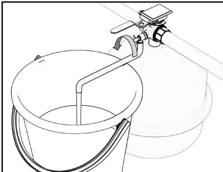
5. De corrosiemonitor kan verwijderd worden uit het kapventielarmatuur.
