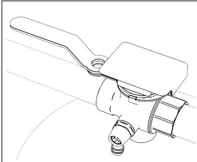
8. Sichern Sie diese Position mit dem beiliegenden Kabelbinder. Schreiben Sie das Datum der Inbetriebnahme auf das Etikett am Kabelbinder. Zur Sicherung können Sie auch eine Schraube mit Mutter oder ein Bügelschloss (in den dafür vorgesehenen Löchern) verwenden.
