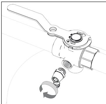
3. Tournez la manette de l'armature de vanne à capuchon perpendiculairement au tuyau.
