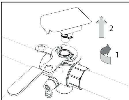
6. Un nouveau moniteur de corrosion peut être monté conformément à l'étape 3 du montage dans le chapitre 6 « Installation ».
