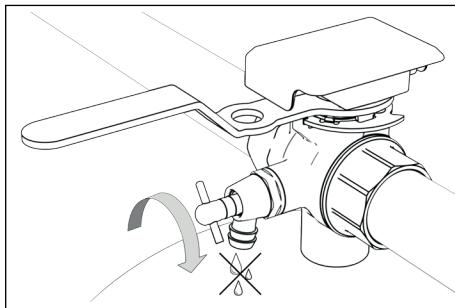
7. Drehen Sie den Betätigungsgriff im Uhrzeigersinn um  $90^\circ$  in seine normale Betriebsposition (= voller Durchlass).
